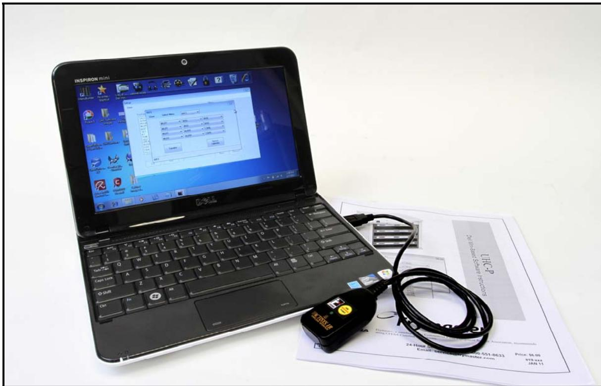
S'il vous plaît noter que le mini-ordinateur, le logiciel UHC-P et dongle IR sont spécialement configurés par Frymaster pour la communication avec le cabinet UHC-P. L'ordinateur et la clé électronique ne sont pas disponibles auprès de leurs fabricants d'origine ou d'autres fournisseurs avec une configuration de l'armoire. Remplaçants doivent être commandés auprès de Frymaster.
